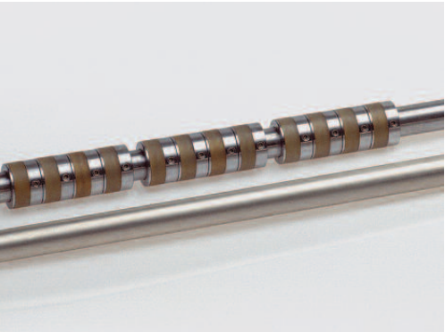
Eine Markierung auf der Welle gibt die Position der Druckschraube des Leimsegmentes vor.
